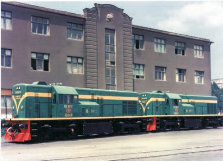
Locomotoras diesel construidas para Renfe por Babcock & Wilcox bajo licencia de la norteamericana General Electric. Archivo Euskotren/Museo Vasco del Ferrocarril
