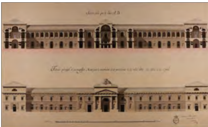
Alzado fachada principal y sección AB de un museo para la conservación de las Bellas Artes, con destino a una capital por Mariano José Lascuráin (1818).
