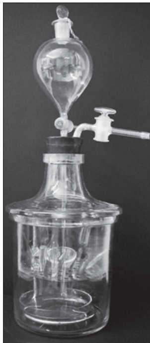
Aparato de Dujardin para llenar ampollas (Foto E. Aramburu).
